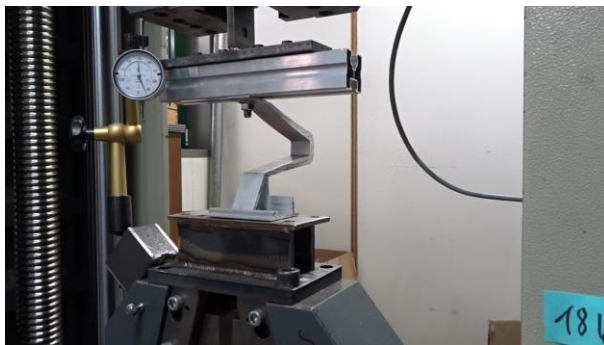
Fig. 15 Test-setup at 1,5 kN
