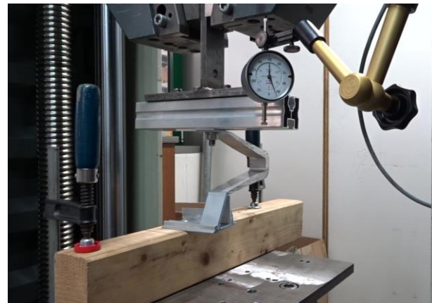
Fig. 10 Test-setup at 1,4 kN
