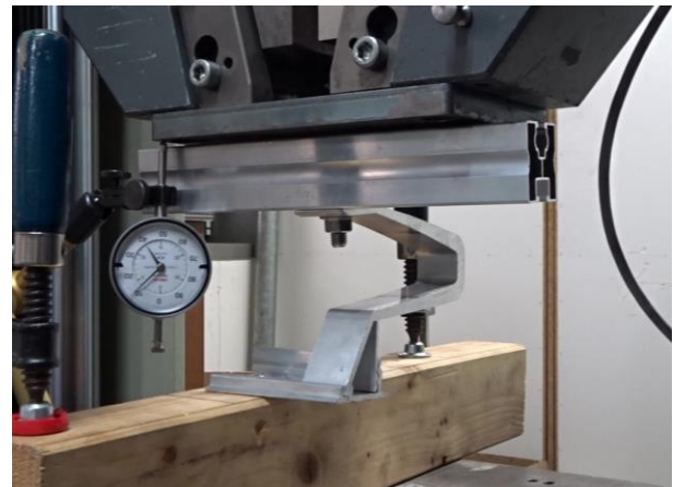
Fig. 20 Test-setup at 1,5 kN
