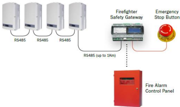
Abbildung 2: Die Anschlüsse des SolarEdge Feuerwehr-Gateways
