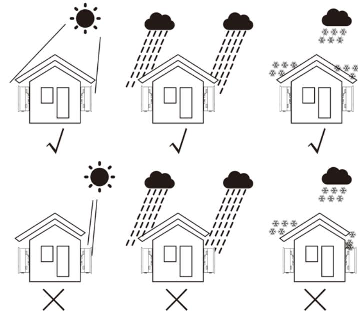
▲ Abbildung 5.1 Empfohlene Installationsposition
