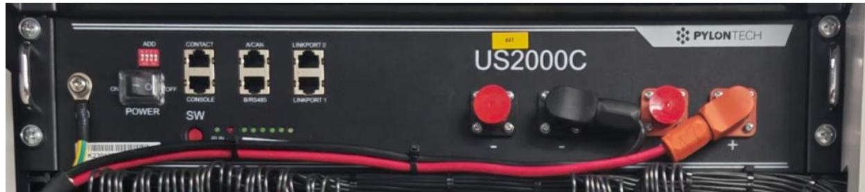
Schalten Sie den Netzschalter des US2000C ein. Drücken Sie die „SW“-Taste des US2000C etwa 3 Sekunden lang und beobachten Sie die Kontrollleuchte des USV-Hosts. Wenn Netzstrom vorhanden ist, leuchtet die Kontrollleuchte grün und zeigt damit einen normalen Start an. Wenn Sie die USV ausschalten müssen, schalten Sie den Netzschalter des US2000C aus und beobachten Sie die LED-Anzeige der USV. Wenn sie aus ist, ist die USV abgeschaltet.
