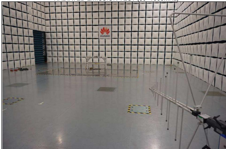
RADIATED EMISSION TEST (1000~6000MHz)
